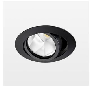
Einbauleuchte mit LED, Bemessungslebensdauer der LED L80/B10 50000 h (Tambient 25°C), Farbwiedergabeindex CRI > 80, Farborttoleranz 2 SDCM (initial), Reflektor mit ovalem Lichtbild, Reflektor Reinstaluminium 99,99% in MIRO-Silver®, segmentiert, Aluminium-Druckguss, pulverbeschichtet, Drehwinkel, Schwenkwinkel +/- 25°, schwarz,
