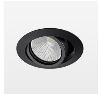
Einbauleuchte mit LED, Bemessungslebensdauer der LED L80/B10 50000 h (Tambient 25°C), Farbwiedergabeindex CRI > 80, Farborttoleranz 2 SDCM (initial), rotationssymmetrischer Reflektor mit kreisförmigen Lichtbild, Reflektor Reinstaluminium 99,99% in MIRO-Silver®, segmentiert und facettiert, LED Hybrid-Technologie, 3D-Linse Silikon zur Reduzierung des Streulichtanteils, Aluminium-Druckguss, pulverbeschichtet, Drehwinkel, Schwenkwinkel +/- 25°, schwarz,
