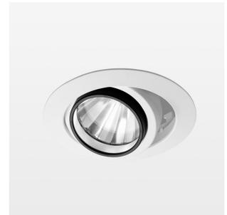
Einbauleuchte mit LED, Bemessungslebensdauer der LED L80/B10 50000 h (Tambient 25°C), Farbwiedergabeindex CRI > 80, Farborttoleranz 2 SDCM (initial), rotationssymmetrischer Reflektor mit kreisförmigen Lichtbild, Reflektor Reinstaluminium 99,99% in MIRO-Silver®, segmentiert und facettiert, LED Hybrid-Technologie, 3D-Linse Silikon zur Reduzierung des Streulichtanteils, Aluminium-Druckguss, pulverbeschichtet, Drehwinkel, Schwenkwinkel +/- 25°, weiß,
