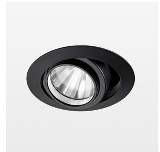
Einbauleuchte mit LED, Bemessungslebensdauer der LED L80/B10 50000 h (Tambient 25°C), Farbwiedergabeindex CRI > 90, Farborttoleranz 2 SDCM (initial), rotationssymmetrischer Reflektor mit kreisförmigen Lichtbild, Reflektor Reinstaluminium 99,99% in MIRO-Silver®, segmentiert und facettiert, LED Hybrid-Technologie, 3D-Linse Silikon zur Reduzierung des Streulichtanteils, Aluminium-Druckguss, pulverbeschichtet, Drehwinkel, Schwenkwinkel +/- 25°, schwarz,
