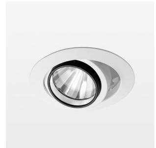
Einbauleuchte mit LED, Bemessungslebensdauer der LED L80/B10 50000 h (Tambient 25°C), Farbwiedergabeindex CRI > 90, Farborttoleranz 2 SDCM (initial), rotationssymmetrischer Reflektor mit kreisförmigen Lichtbild, Reflektor Reinstaluminium 99,99% in MIRO-Silver®, segmentiert und facettiert, LED Hybrid-Technologie, 3D-Linse Silikon zur Reduzierung des Streulichtanteils, Aluminium-Druckguss, pulverbeschichtet, Drehwinkel, Schwenkwinkel +/- 25°, weiß,
