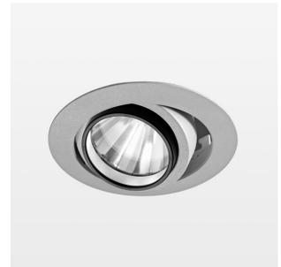
Einbauleuchte mit LED, Bemessungslebensdauer der LED L80/B10 50000 h (Tambient 25°C), Farbwiedergabeindex CRI > 96, Farborttoleranz 2 SDCM (initial), rotationssymmetrischer Reflektor mit kreisförmigen Lichtbild, Reflektor Reinstaluminium 99,99% in MIRO-Silver®, segmentiert und facettiert, LED Hybrid-Technologie, 3D-Linse Silikon zur Reduzierung des Streulichtanteils, Aluminium-Druckguss, pulverbeschichtet, Drehwinkel, Schwenkwinkel +/- 25°, silber,
