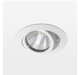
Einbauleuchte mit LED, Bemessungslebensdauer der LED L80/B10 50000 h (Tambient 25°C), Farbwiedergabeindex CRI > 96, Farborttoleranz 2 SDCM (initial), rotationssymmetrischer Reflektor mit kreisförmigen Lichtbild, Reflektor Reinstaluminium 99,99% in MIRO-Silver®, segmentiert und facettiert, LED Hybrid-Technologie, 3D-Linse Silikon zur Reduzierung des Streulichtanteils, Aluminium-Druckguss, pulverbeschichtet, Drehwinkel, Schwenkwinkel +/- 25°, weiß,
