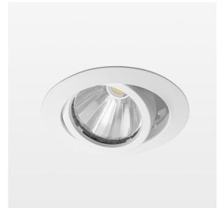
Einbauleuchte mit LED, Bemessungslebensdauer der LED L80/B10 50000 h (Tambient 25°C), Farbwiedergabeindex CRI > 80, Farborttoleranz 3 SDCM (initial), rotationssymmetrischer Reflektor mit kreisförmigen Lichtbild, Reflektor Reinstaluminium 99,99% in MIRO-Silver®, segmentiert und facettiert, LED Hybrid-Technologie, 3D-Linse Silikon zur Reduzierung des Streulichtanteils, Aluminium-Druckguss, pulverbeschichtet, Drehwinkel, Schwenkwinkel +/- 25°, weiß,
