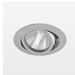
Einbauleuchte mit LED, Bemessungslebensdauer der LED L80/B10 50000 h (Tambient 25°C), Farbwiedergabeindex CRI > 95, Farborttoleranz 2 SDCM (initial), rotationssymmetrischer Reflektor mit kreisförmigen Lichtbild, Reflektor Reinstaluminium 99,99% in MIRO-Silver®, segmentiert und facettiert, LED Hybrid-Technologie, 3D-Linse Silikon zur Reduzierung des Streulichtanteils, Aluminium-Druckguss, pulverbeschichtet, Drehwinkel, Schwenkwinkel +/- 25°, silber,
