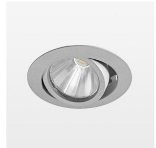
Einbauleuchte mit LED, Bemessungslebensdauer der LED L80/B10 50000 h (Tambient 25°C), Farbwiedergabeindex CRI > 90, Farborttoleranz 2 SDCM (initial), rotationssymmetrischer Reflektor mit kreisförmigen Lichtbild, Reflektor Reinstaluminium 99,99% in MIRO-Silver®, segmentiert und facettiert, LED Hybrid-Technologie, 3D-Linse Silikon zur Reduzierung des Streulichtanteils, Aluminium-Druckguss, pulverbeschichtet, Drehwinkel, Schwenkwinkel +/- 25°, silber,
