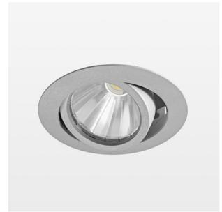
Einbauleuchte mit LED, Bemessungslebensdauer der LED L80/B10 50000 h (Tambient 25°C), Farbwiedergabeindex CRI > 80, Farborttoleranz 3 SDCM (initial), rotationssymmetrischer Reflektor mit kreisförmigen Lichtbild, Reflektor Reinstaluminium 99,99% in MIRO-Silver®, segmentiert und facettiert, LED Hybrid-Technologie, 3D-Linse Silikon zur Reduzierung des Streulichtanteils, Aluminium-Druckguss, pulverbeschichtet, Drehwinkel, Schwenkwinkel +/- 25°, silber,
