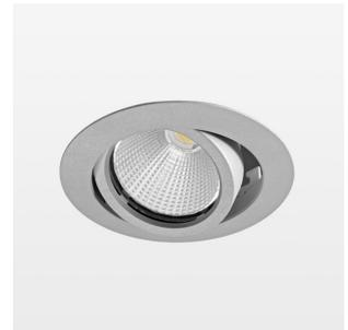
Einbauleuchte mit LED, Bemessungslebensdauer der LED L80/B10 50000 h (Tambient 25°C), Farbwiedergabeindex CRI > 90, Farborttoleranz 2 SDCM (initial), rotationssymmetrischer Reflektor mit kreisförmigen Lichtbild, Reflektor Reinstaluminium 99,99% in MIRO-Silver®, segmentiert und facettiert, Aluminium-Druckguss, pulverbeschichtet, Drehwinkel, Schwenkwinkel +/- 25°, silber,
