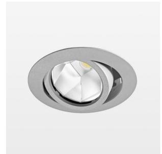
Einbauleuchte mit LED, Bemessungslebensdauer der LED L80/B10 50000 h (Tambient 25°C), Farbwiedergabeindex CRI > 90, Farborttoleranz 2 SDCM (initial), Reflektor mit ovalem Lichtbild, Reflektor Reinstaluminium 99,99% in MIRO-Silver®, segmentiert, Aluminium-Druckguss, pulverbeschichtet, Drehwinkel, Schwenkwinkel +/- 25°, silber,
