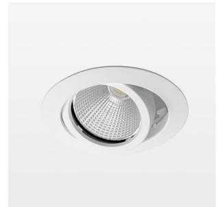
Einbauleuchte mit LED, Bemessungslebensdauer der LED L80/B10 50000 h (Tambient 25°C), Farbwiedergabeindex CRI > 90, Farborttoleranz 2 SDCM (initial), rotationssymmetrischer Reflektor mit kreisförmigen Lichtbild, Reflektor Reinstaluminium 99,99% in MIRO-Silver®, segmentiert und facettiert, Aluminium-Druckguss, pulverbeschichtet, Drehwinkel, Schwenkwinkel +/- 25°, weiß,
