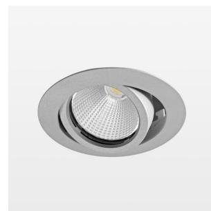
Einbauleuchte mit LED, Bemessungslebensdauer der LED L80/B10 50000 h (Tambient 25°C), Farbwiedergabeindex CRI > 90, Farborttoleranz 2 SDCM (initial), rotationssymmetrischer Reflektor mit kreisförmigen Lichtbild, Reflektor Reinstaluminium 99,99% in MIRO-Silver®, segmentiert und facettiert, LED Hybrid-Technologie, 3D-Linse Silikon zur Reduzierung des Streulichtanteils, Aluminium-Druckguss, pulverbeschichtet, Drehwinkel, Schwenkwinkel +/- 25°, silber,
