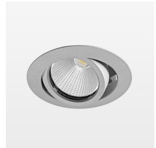
Einbauleuchte mit LED, Bemessungslebensdauer der LED L80/B10 50000 h (Tambient 25°C), Farbwiedergabeindex CRI > 80, Farborttoleranz 2 SDCM (initial), rotationssymmetrischer Reflektor mit kreisförmigen Lichtbild, Reflektor Reinstaluminium 99,99% in MIRO-Silver®, segmentiert und facettiert, LED Hybrid-Technologie, 3D-Linse Silikon zur Reduzierung des Streulichtanteils, Aluminium-Druckguss, pulverbeschichtet, Drehwinkel, Schwenkwinkel +/- 25°, silber,
