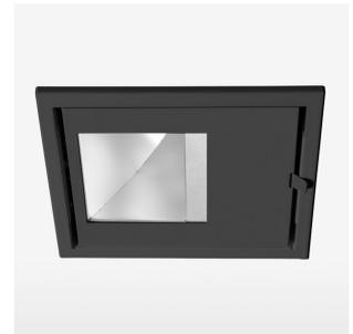
Einbauleuchte mit LED, Bemessungslebensdauer der LED L80/B10 > 50000 h, Farbwiedergabeindex CRI > 96, Farborttoleranz 3 SDCM (initial), Reflektor mit asymmetrischem Lichtbild, Schwenkwinkel 30°, Leuchtengehäuse Stahlblech, pulverbeschichtet schwarz, separate Treibereinheit
