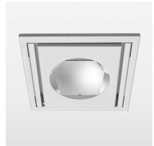
Einbauleuchte mit LED, Bemessungslebensdauer der LED L80/B10 > 50000 h, Farbwiedergabeindex CRI > 70, Farborttoleranz 2 SDCM (initial), Reflektor mit ovalem Lichtbild, Schwenkwinkel 30°, Leuchtgehäuse Stahlblech, pulverbeschichtet Weiss, separate Treibereinheit
