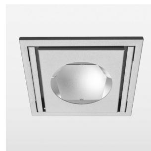
Einbauleuchte mit LED, Bemessungslebensdauer der LED L80/B10 > 50000 h, Farbwiedergabeindex CRI > 90, Farborttoleranz 2 SDCM (initial), Reflektor mit ovalem Lichtbild, Schwenkwinkel 30°, Leuchtgehäuse Stahlblech, pulverbeschichtet silber, separate Treibereinheit
