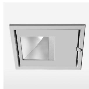
Einbauleuchte mit LED, Bemessungslebensdauer der LED L80/B10 > 50000 h, Farbwiedergabeindex CRI > 90, Farborttoleranz 2 SDCM (initial), Reflektor mit asymmetrischem Lichtbild, Schwenkwinkel 30°, Leuchtengehäuse Stahlblech, pulverbeschichtet silber, separate Treibereinheit
