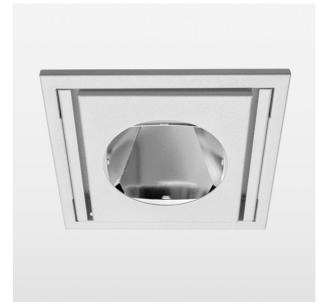
Einbauleuchte mit LED, Bemessungslebensdauer der LED L80/B10 > 50000 h, Farbwiedergabeindex CRI > 90, Farborttoleranz 2 SDCM (initial), rotationssymmetrischer Reflektor mit kreisförmigen Lichtbild, Reflektor Reinstaluminium 99,99% in MIRO-Silver®, Schwenkwinkel 30°, Leuchtgehäuse Stahlblech, pulverbeschichtet Weiss, separate Treibereinheit
