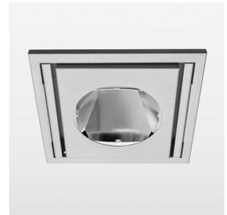
Einbauleuchte mit LED, Bemessungslebensdauer der LED L80/B10 > 50000 h, Farbwiedergabeindex CRI > 80, Farborttoleranz 3 SDCM (initial), Reflektor mit kreisförmigem Lichtbild, Schwenkwinkel 30°, Leuchtgehäuse Stahlblech, pulverbeschichtet silber, separate Treibereinheit
