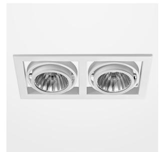
Einbauleuchte mit LED, Bemessungslebensdauer der LED L80/B10 > 50000 h, Farbwiedergabeindex CRI > 80, Farborttoleranz 2 SDCM (initial), rotationssymmetrischer Reflektor mit kreisförmigen Lichtbild, Schwenkwinkel +/- 30°, Leuchtgehäuse Stahlblech, pulverbeschichteter Weiss, separate Treibereinheit
