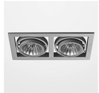
Einbauleuchte mit LED, Bemessungslebensdauer der LED L80/B10 > 50000 h, Farbwiedergabeindex CRI > 90, Farborttoleranz 2 SDCM (initial), rotationssymmetrischer Reflektor mit kreisförmigen Lichtbild, Schwenkwinkel +/- 30°, Leuchtgehäuse Stahlblech, pulverbeschichtet schwarz, separate Treibereinheit
