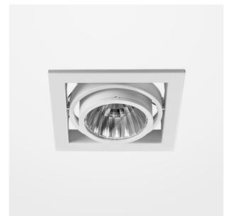
Einbauleuchte mit LED, Bemessungslebensdauer der LED L80/B10 > 50000 h, Farbwiedergabeindex CRI > 80, Farborttoleranz 2 SDCM (initial), Reflektor mit kreisförmigem Lichtbild, Reflektor Reinstaluminium 99,99% in MIRO-Silver®, kardanisch, Schwenkwinkel +/-30°, Leuchtgehäuse Stahlblech, pulverbeschichtet, Weiss, separate Treibereinheit
