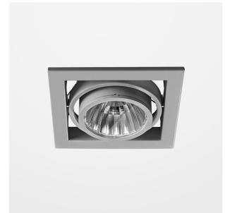
Einbauleuchte mit LED, Bemessungslebensdauer der LED L80/B10 > 50000 h, Farbwiedergabeindex CRI > 90, Farborttoleranz 2 SDCM (initial), Reflektor mit kreisförmigem Lichtbild, Reflektor Reinstaluminium 99,99% in MIRO-Silver®, kardanisch, Schwenkwinkel +/-30°, Leuchtgehäuse Stahlblech, pulverbeschichtet, silber, separate Treibereinheit
