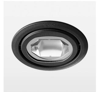
Einbauleuchte mit LED, Bemessungslebensdauer der LED L80/B10 > 50000 h, Farbwiedergabeindex CRI > 80, Farborttoleranz 2 SDCM (initial), Reflektor mit kreisförmigem Lichtbild, Reflektor Reinstaluminium 99,99% in MIRO-Silver®, Drehwinkel 170°, Schwenkwinkel +/-30°, Leuchtgehäuse Stahlblech, pulverbeschichtet, schwarz, separate Treibereinheit
