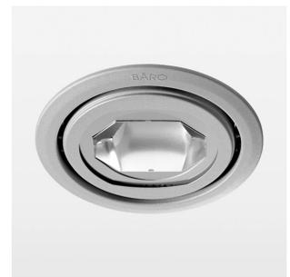
Einbauleuchte mit LED, Bemessungslebensdauer der LED L80/B10 > 50000 h, Farbwiedergabeindex CRI > 70, Farborttoleranz 2 SDCM (initial), Reflektor mit kreisförmigem Lichtbild, Reflektor Reinstaluminium 99,99% in MIRO-Silver®, Drehwinkel 170°, Schwenkwinkel +/-30°, Leuchtgehäuse Stahlblech, pulverbeschichtet, silber, separate Treibereinheit
