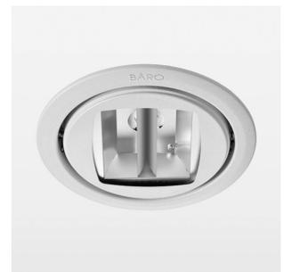
Einbauleuchte mit LED, Bemessungslebensdauer der LED L80/B10 > 50000 h, Farbwiedergabeindex CRI > 90, Farborttoleranz 2 SDCM (initial), Reflektor mit doppelt asymmetrischem Lichtbild, Reflektor Reinstaluminium 99,99% in MIRO-Silver®, Drehwinkel 170°, Schwenkwinkel +/-30°, Leuchtengehäuse Stahlblech, pulverbeschichtet, Weiss, separate Treibereinheit
