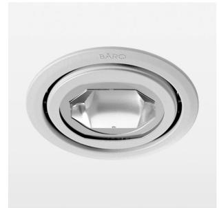
Einbauleuchte mit LED, Bemessungslebensdauer der LED L80/B10 > 50000 h, Farbwiedergabeindex CRI > 80, Farborttoleranz 3 SDCM (initial), Reflektor mit ovalem Lichtbild, Reflektor Reinstaluminium 99,99% in MIRO-Silver®, Drehwinkel 170°, Schwenkwinkel +/-30°, Leuchtengehäuse Stahlblech, pulverbeschichtet, Weiss, separate Treibereinheit
