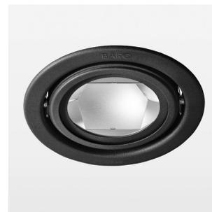
Einbauleuchte mit LED, Bemessungslebensdauer der LED L80/B10 > 50000 h, Farbwiedergabeindex CRI > 90, Farborttoleranz 2 SDCM (initial), Reflektor mit kreisförmigem Lichtbild, Reflektor Reinstaluminium 99,99% in MIRO-Silver®, Schwenkwinkel +/-25°, Leuchtgehäuse Stahlblech, pulverbeschichtet, schwarz, separate Treibereinheit
