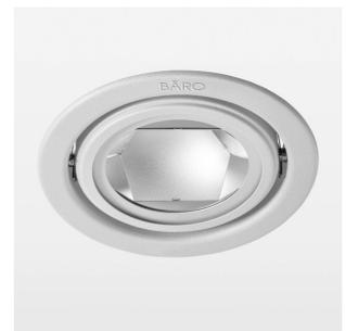
Einbauleuchte mit LED, Bemessungslebensdauer der LED L80/B10 > 50000 h, Farbwiedergabeindex CRI > 80, Farborttoleranz 2 SDCM (initial), Reflektor mit kreisförmigem Lichtbild, Reflektor Reinstaluminium 99,99% in MIRO-Silver®, Schwenkwinkel +/-25°, Leuchtgehäuse Stahlblech, pulverbeschichtet, Weiss, separate Treibereinheit
