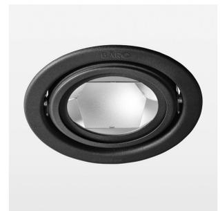
Einbauleuchte mit LED, Bemessungslebensdauer der LED L80/B10 > 50000 h, Farbwiedergabeindex CRI > 90, Farborttoleranz 2 SDCM (initial), Reflektor mit ovalem Lichtbild, Reflektor Reinstaluminium 99,99% in MIRO-Silver®, Schwenkwinkel +/-25°, Leuchtengehäuse Stahlblech, pulverbeschichtet, schwarz, separate Treibereinheit
