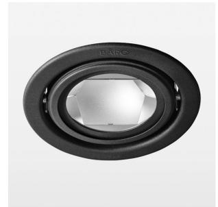
Einbauleuchte mit LED, Bemessungslebensdauer der LED L80/B10 > 50000 h, Farbwiedergabeindex CRI > 82, Farborttoleranz 2 SDCM (initial), Reflektor mit kreisförmigem Lichtbild, Reflektor Reinstaluminium 99,99% in MIRO-Silver®, Schwenkwinkel +/-25°, Leuchtgehäuse Stahlblech, pulverbeschichtet, schwarz, separate Treibereinheit
