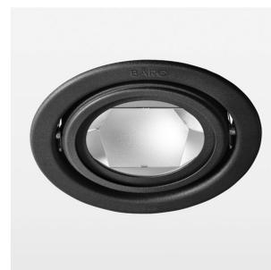
Einbauleuchte mit LED, Bemessungslebensdauer der LED L80/B10 > 50000 h, Farbwiedergabeindex CRI > 82, Farborttoleranz 2 SDCM (initial), Reflektor mit kreisförmigem Lichtbild, Reflektor Reinstaluminium 99,99% in MIRO-Silver®, Schwenkwinkel +/-25°, Leuchtgehäuse Stahlblech, pulverbeschichtet, schwarz, separate Treibereinheit
