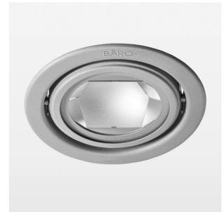
Einbauleuchte mit LED, Bemessungslebensdauer der LED L80/B10 > 50000 h, Farbwiedergabeindex CRI > 80, Farborttoleranz 3 SDCM (initial), Reflektor mit kreisförmigem Lichtbild, Reflektor Reinstaluminium 99,99% in MIRO-Silver®, Schwenkwinkel +/-25°, Leuchtgehäuse Stahlblech, pulverbeschichtet, silber, separate Treibereinheit
