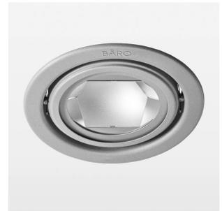
Einbauleuchte mit LED, Bemessungslebensdauer der LED L80/B10 > 50000 h, Farbwiedergabeindex CRI > 82, Farborttoleranz 2 SDCM (initial), Reflektor mit ovalem Lichtbild, Reflektor Reinstaluminium 99,99% in MIRO-Silver®, Schwenkwinkel +/-25°, Leuchtengehäuse Stahlblech, pulverbeschichtet, silber, separate Treibereinheit
