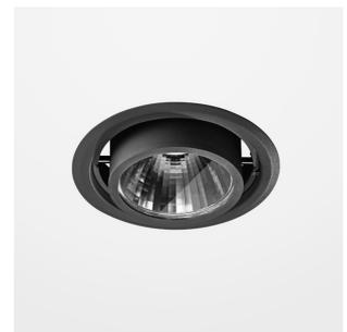
Einbauleuchte mit LED, Bemessungslebensdauer der LED L80/B10 > 50000 h, Farbwiedergabeindex CRI > 80, Farborttoleranz 2 SDCM (initial), Reflektor mit kreisförmigem Lichtbild, Reflektor Reinstaluminium 99,99%, segmentiert und facettiert, dreh- und schwenkbar, inkl. Abschlussglas, Leuchtengehäuse Stahlblech, pulverbeschicht, separate Treibereinheit
