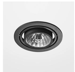
Einbauleuchte mit LED, Bemessungslebensdauer der LED L80/B10 > 50000 h, Farbwiedergabeindex CRI > 90, Farborttoleranz 2 SDCM (initial), achssymmetrischer Reflektor mit kreisförmigem Lichtbild, Reflektor Reinstaluminium 99,99%, segmentiert und facettiert, kardanisch, inkl. Abschlussglas, Leuchtgehäuse Stahlblech, pulverbeschicht, separate Treibereinheit
