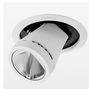
Halbeinbauleuchte mit LED, Bemessungslebensdauer der LED L80/B10 > 50000 h, Farbwiedergabeindex CRI > 82, Farbortoleranz 2 SDCM (initial), Reflektor mit ovalem Lichtbild, Reflektor Reinstaluminium 99,99% in MIRO-Silver®, Leuchtenkopf Aluminium-Druckguss, pulverbeschichtet, Drehwinkel 170°, Schwenkwinkel 65°, Einbaueinheit Stahlblech, lichtdicht, Weiss, separate Treibereinheit
