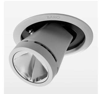
Halbeinbauleuchte mit LED, Bemessungslebensdauer der LED L80/B10 > 50000 h, Farbwiedergabeindex CRI > 82, Farborttoleranz 2 SDCM (initial), Reflektor mit kreisförmigem Lichtbild, Reflektor Reinstaluminium 99,99% in MIRO-Silver®, Leuchtenkopf Aluminium-Druckguss, pulverbeschichtet, Drehwinkel 170°, Schwenkwinkel 65°, Einbaugehäuse Stahlblech, lichtdicht, silber, separate Treibereinheit
