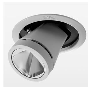
Halbeinbauleuchte mit LED, Bemessungslebensdauer der LED L80/B10 > 50000 h, Farbwiedergabeindex CRI > 80, Farbortoleranz 2 SDCM (initial), Reflektor mit kreisförmigem Lichtbild, Reflektor Reinstaluminium 99,99% in MIRO-Silver®, Leuchtenkopf Aluminium-Druckguss, pulverbeschichtet, Drehwinkel 170°, Schwenkwinkel 65°, Einbaugehäuse Stahlblech, lichtdicht, silber, separate Treibereinheit
