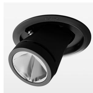
Halbeinbauleuchte mit LED, Bemessungslebensdauer der LED L80/B10 > 50000 h, Farbwiedergabeindex CRI > 90, Farborttoleranz 2 SDCM (initial), Reflektor mit kreisförmigem Lichtbild, Reflektor Reinstaluminium 99,99% in MIRO-Silver®, Leuchtenkopf Aluminium-Druckguss, pulverbeschichtet, Drehwinkel 170°, Schwenkwinkel 65°, Einbaugehäuse Stahlblech, lichtdicht, schwarz, separate Treibereinheit
