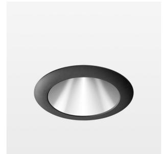
Einbau-Downlight mit LED, Bemessungslebensdauer der LED L80/B10 > 50000 h, Farbwiedergabeindex CRI > 80, Farborttoleranz 2 SDCM (initial), Reflektor mit homogenen Lichtbild, Diffusorlinse Silikon, transluzent, Darklightreflektor, Aluminium, bedampft, hochglänzend, Leuchtenkopf Aluminium-Druckguss, pulverbeschichtet, ; Einbauring Aluminium-Druckguss, Frontring und Blende Kunststoff, Schwarz, separate Treibereinheit
