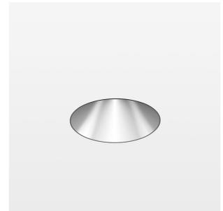
Einbau-Downlight, deckenbündig mit LED, Bemessungslebensdauer der LED L80/B10 > 50000 h, Farbwiedergabeindex CRI > 80, Farborttoleranz 2 SDCM (initial), Reflektor mit homogenen Lichtbild, Diffusorlinse Silikon, transluzent, Darklightreflektor, Aluminium, bedampft, hochglänzend, Leuchtenkopf Aluminium-Druckguss, schwarz eloxiert, Einputzring Aluminium-Druckguss, Blende Kunststoff, Schwarz, separate Treibereinheit
