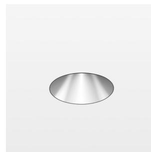
Einbau-Downlight, deckenbündig mit LED, Bemessungslebensdauer der LED L80/B10 > 50000 h, Farbwiedergabeindex CRI > 80, Farborttoleranz 2 SDCM (initial), Reflektor mit homogenen Lichtbild, Diffusorlinse Silikon, transluzent, Darklightreflektor, Aluminium, bedampft, hochglänzend, Leuchtenkopf Aluminium-Druckguss, schwarz eloxiert, Einputzring Aluminium-Druckguss, Blende Kunststoff, Schwarz, separate Treibereinheit
