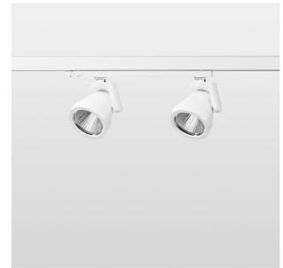
Aufbauleuchte mit zwei Lichtköpfen mit LED, Bemessungslebensdauer der LED L80/B10 > 50000 h, Farbwiedergabeindex CRI > 90, Farborttoleranz 2 SDCM (initial), Reflektor mit ovalem Lichtbild, Reflektor Reinstaluminium 99,99% in MIRO-Silver®, segmentiert, Leuchtenkopf/Halteam Aluminium-Druckguss, weiß, Drehwinkel 330°, Schwenkwinkel +/-85°, In-Track-Adapter, On/Off, 220-240 V~ / 50-60 Hz, max. Anzahl Leuchten pro Stromkreis 27 Stk. / B16A
