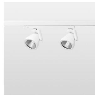
Aufbauleuchte mit zwei Lichtköpfen mit LED, Bemessungslebensdauer der LED L80/B10 > 50000 h, Farbwiedergabeindex CRI > 80, Farborttoleranz 2 SDCM (initial), Reflektor mit ovalem Lichtbild, Reflektor Reinstaluminium 99,99% in MIRO-Silver®, segmentiert, Leuchtenkopf/Halteam Aluminium-Druckguss, weiß, Drehwinkel 330°, Schwenkwinkel +/-85°, In-Track-Adapter, On/Off, 220-240 V~ / 50-60 Hz, max. Anzahl Leuchten pro Stromkreis 27 Stk. / B16A
