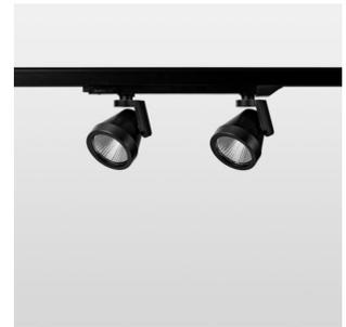
Aufbauleuchte mit zwei Lichtköpfen mit LED, Bemessungslebensdauer der LED L80/B10 > 50000 h, Farbwiedergabeindex CRI > 90, Farborttoleranz 2 SDCM (initial), Reflektor mit ovalem Lichtbild, Reflektor Reinstaluminium 99,99% in MIRO-Silver®, segmentiert, Leuchtenkopf/Halteam Aluminium-Druckguss, schwarz, Drehwinkel 330°, Schwenkwinkel +/-85°, In-Track-Adapter, On/Off, 220-240 V~ / 50-60 Hz, max. Anzahl Leuchten pro Stromkreis 27 Stk. / B16A
