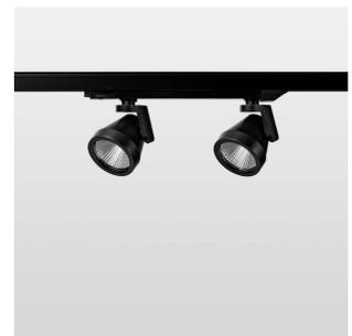
Aufbauleuchte mit zwei Lichtköpfen mit LED, Bemessungslebensdauer der LED L80/B10 > 50000 h, Farbwiedergabeindex CRI > 90, Farbortoleranz 2 SDCM (initial), rotationssymmetrischer Reflektor mit kreisförmigen Lichtbild, Reflektor Reinstaluminium 99,99% in MIRO-Silver®, segmentiert, Leuchtenkopf/Haltearm Aluminium-Druckguss, schwarz, Drehwinkel 330°, Schwenkwinkel +/-85°, In-Track-Adapter, On/Off, 220-240 V~ / 50-60 Hz, max. Anzahl Leuchten pro Stromkreis 27 Stk. / B16A
